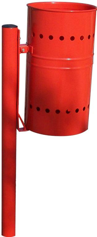
Contenitore a forma cilindrica con nervature, ottenuto dalla calandratura a freddo di lamiera sp. 10/10 preforata con punzonatrice, chiuso tramite elettrosaldatura.
